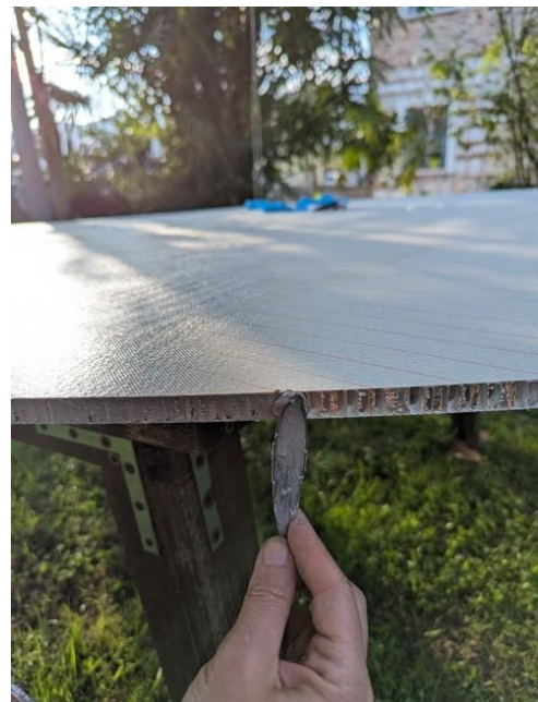
Figura 3 Sigillatura bordi con resina bicomponente
