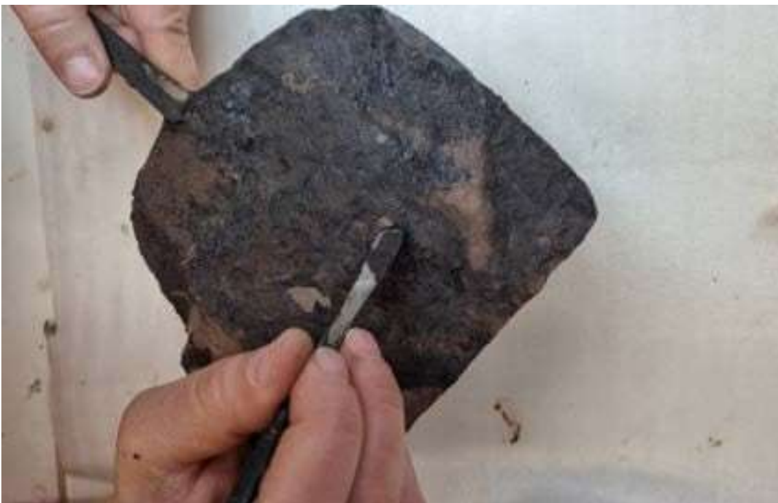
Integrazione delle lacune a supporto delle fragilità materiche con Epo 155
